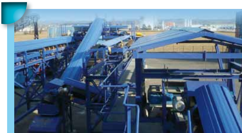
Les métaux sont extraits des mâchefers par des électro-aimants et des courants de Foucault pour être valorisés.
