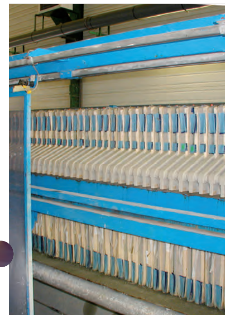
Filtre-pressé utilisé pour la précipitation sélective
