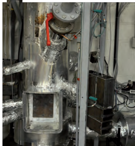
Pilote d'incinération pour les études de comportement des espèces minérales
