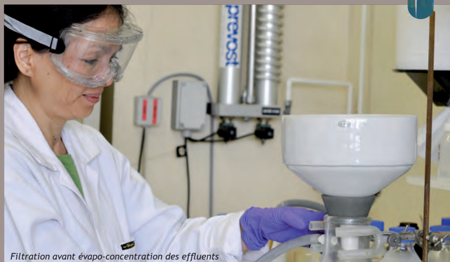
Filtration avant évapo-concentration des effluents
