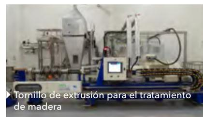
Tornillo de extrusión para el tratamiento de madera
