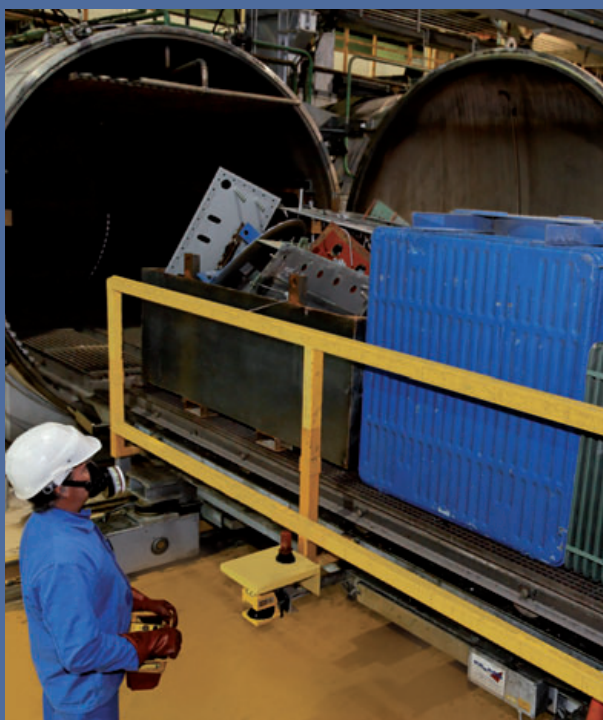
Autoclave de décontamination à Saint-Vulbas
