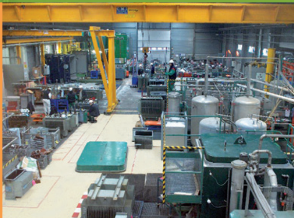
Atelier de réhabilitation de transformateurs à Izeaux
